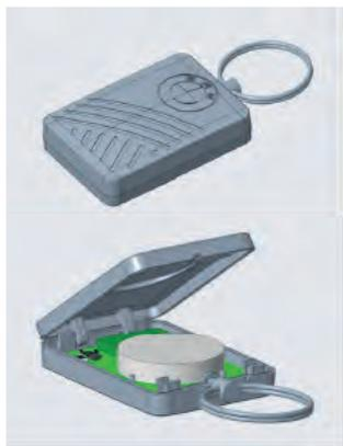
Cette caractéristique permettra au dispositif de fonctionner de manière autonome un certain temps, en fonction du temps de déconnexion pendant la durée de vie du produit p.ex. pendant l'entretien de la voiture ou en cas de vol. La batterie de sauvegarde se rechargera automatiquement lorsqu'elle est reconnectée à la batterie de la voiture.
