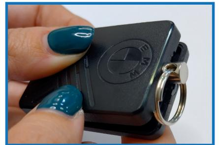
Öffnen Sie das BMW Driver Tag mithilfe eines Schlitzschraubendrehers. Ersetzen Sie nun die entladene Batterie mit einer neuen CR2450-Batterie.
